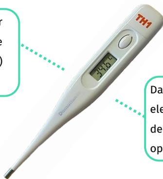
Das Display (Aktuator) wandelt elektrischen Strom in ein für den Menschen sichtbares optisches Signal um.
